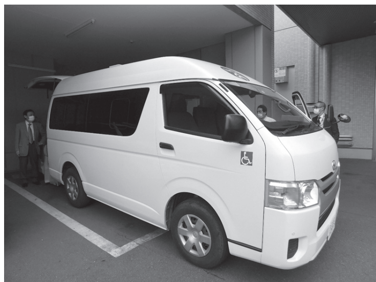
図4：後部座席が陰圧設定可能なドクターカー
